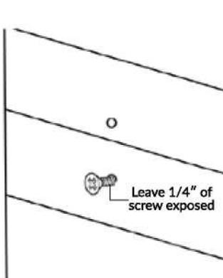
Installieren Sie die mitgelieferte Schraube in das untere Bohrloch, wobei 1/4" der
