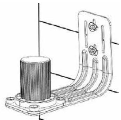
Bringen Sie die Schraube durch das obere Bohrloch an.
