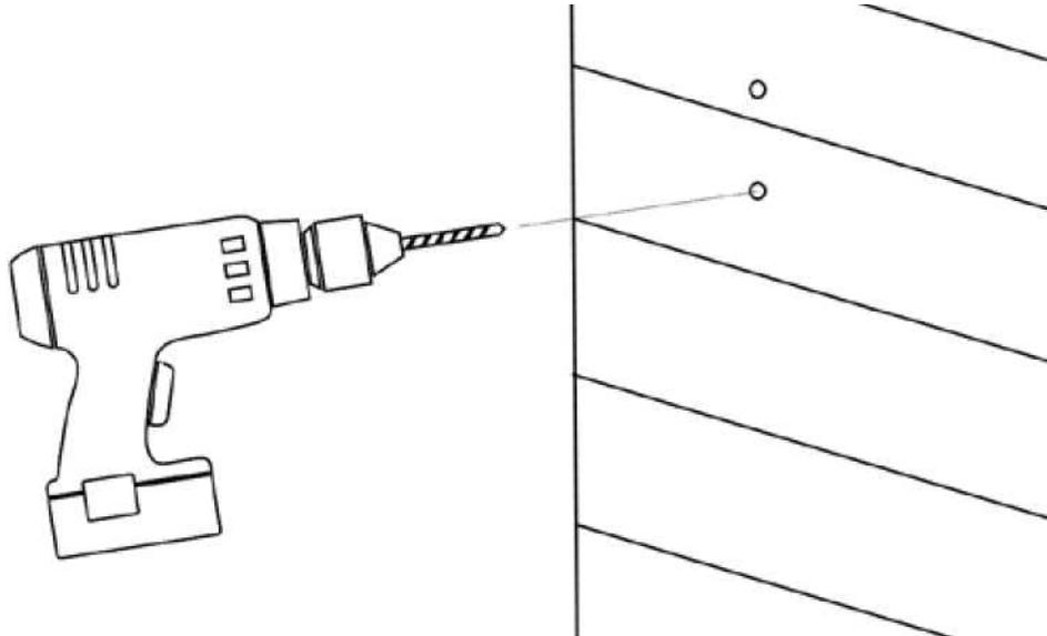
3. Installieren Sie die untere Schraube in das vorgebohrte Loch und lassen Sie 1/4 Zoll des Zwischenraums zwischen der Oberfläche und dem Kopf der Schraube frei.
